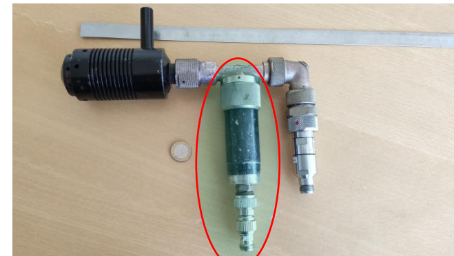
S-Band: Evanescent-mode attenuator, Mfg Spinner
